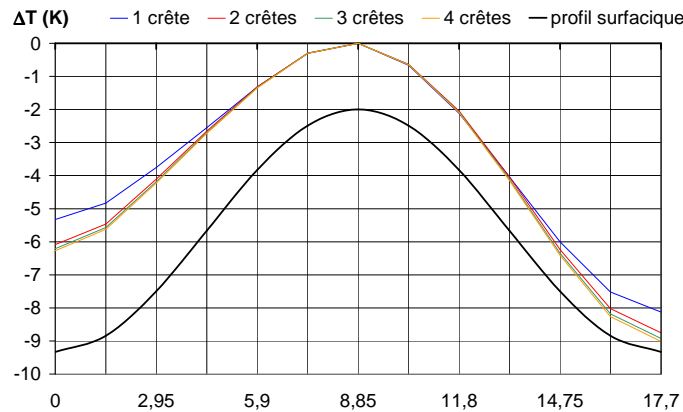
FIG. 4.11 – Écarts de températures avec la crête centrale, en surface du profil, pour les quatre longueurs testées : 17.7 cm (1 crête), 35.4 cm (2 crêtes), 53.1 cm (3 crêtes), et 70.8 cm (4 crêtes) –simulation le 15/06/2000 à 11h
