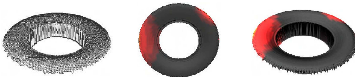
FIG. C.1 – Extraits des travaux de Gray et al. : maillage 3D du pneu, image infrarouge du pneu, puis obtention d'une texture thermique par placage de l'image infrarouge sur le maillage 3D
