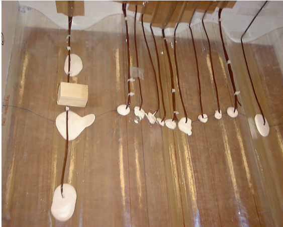
FIG. F.3 – Thermocouples de surface fixés, dans le moule de la maquette définitive, avec une petite quantité de plâtre presque pris
