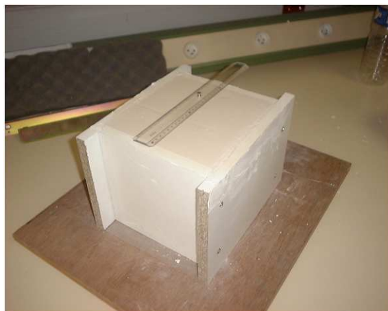
FIG. 4.21 – Cube de plâtre, de 20 cm d’arête, dans son moule, avant démoulage
