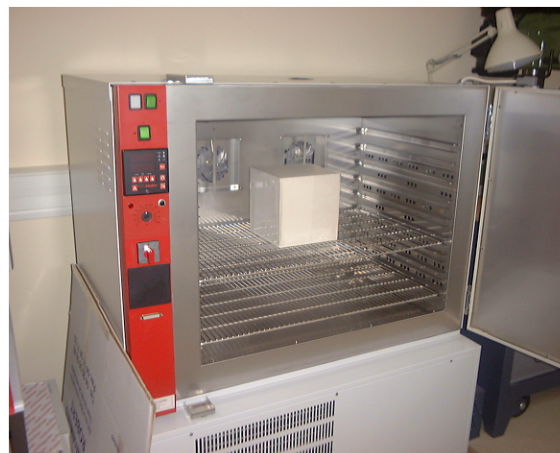
FIG. 4.22 – Cube de plâtre, de 20 cm d’arête, placé dans l’étuve
