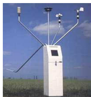
FIG. G.2 – Station météorologique autonome ENERCO 407 avec cinq capteurs mesurant la vitesse et la direction du vent, la température et l'humidité de l'air, et l'éclairement solaire visible
